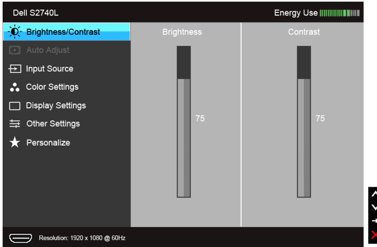
**NOTA:** L'opzione AUTO ADJUST (Regolazione automatica) è disponibile solo quando si usa il connettore analogico (VGA).
